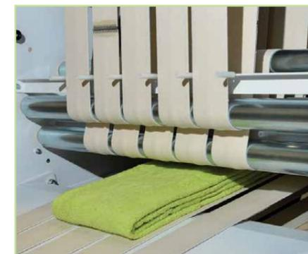
hasta de un largo de 2300mm. El Plegador de Toallas **T.towel** está equipado con dos pliegues transversal. Cada pliegue transversal es realizado mediante la inversión de las cintas de transporte, en combinación con un impulso de aire. El resultado es un pliegue muy preciso y ajustado.
