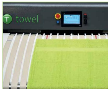
El Plegador de Toallas **T.towel** está dotada de una función especial para doblar piezas que necesitan correcciones adicionales, antes de ser doblado, como sábanas ajustables. Después de colocar la sábana con elásticos sobre la mesa de alimentación y presionando el botón, la prenda es introducida en la máquina y se detiene automáticamente para corregir el extremo final de la prenda. A continuación, el operador empuja el botón una segunda vez, para que el proceso de plegado se pueda iniciar.
